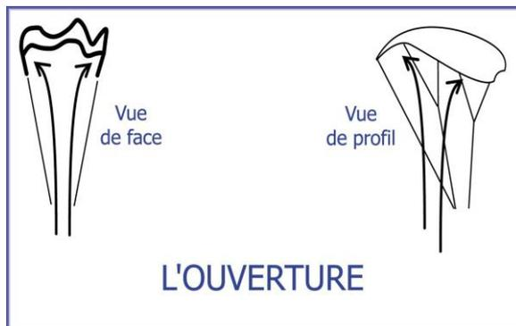
L'étalement transversal s'opère grâce à la poussée de l'air sur les stabilisateurs.
